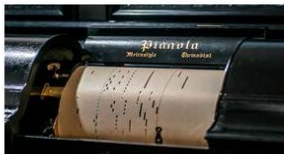
Рис. 1. Перфорована стрічка (ролик) піанолі
